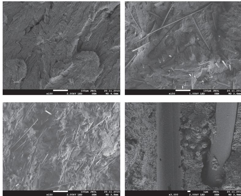
**Figure 1:** Micrographs of supramolecular structure: a) initial PTFE (× 150); b) PTFE + 1wt.% CF (× 150); c) PTFE + 5 wt.% CF (× 150); d) PTFE + CF (× 3000).
